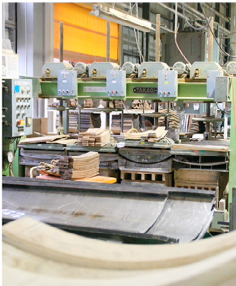
Izq. Sup.- Cámara de vaporizado. Der. sup.- Prensa múltiple con vapor. Izq. Inf.- Prensa múltiple con doble molde (macho-hembra). Der Inf.- Prensa para curvado con molde macho y banda de apoyo
