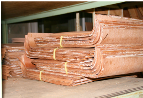
Resultado obtenido mediante el proceso de curvado por laminación (izq) y por prensado con banda de apoyo en cara convexa (der)
