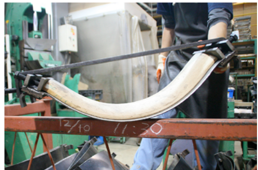
Resultado obtenido mediante el proceso de curvado por laminación (izq) y por prensado con banda de apoyo en cara convexa (der)
