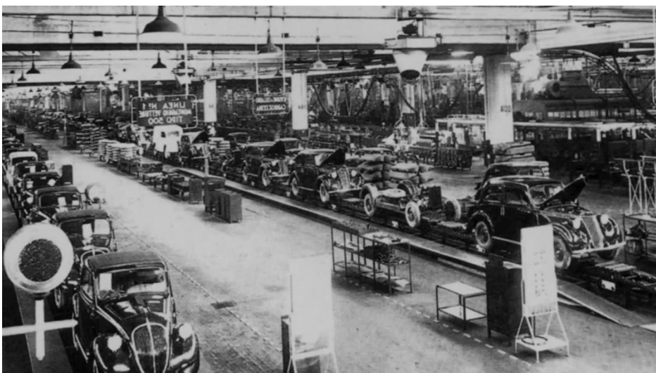
Figura 7 . Lingotto: Cadena de montaje final en planta 5ª (Archivo FIAT)
