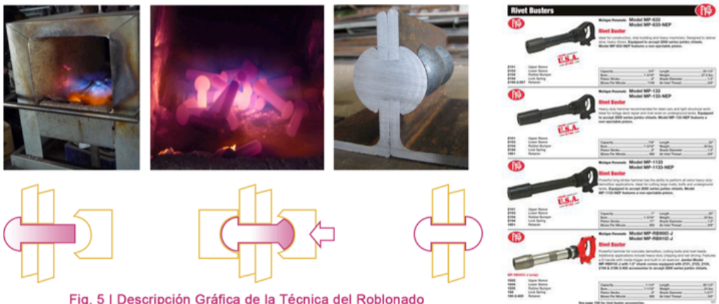
Fig. 5 | Descripción Gráfica de la Técnica del Roblonado
